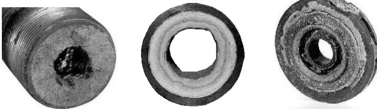
Рисунок 1 – Асфальтосмолопарафиновые отложения в насосно-компрессорных трубах
