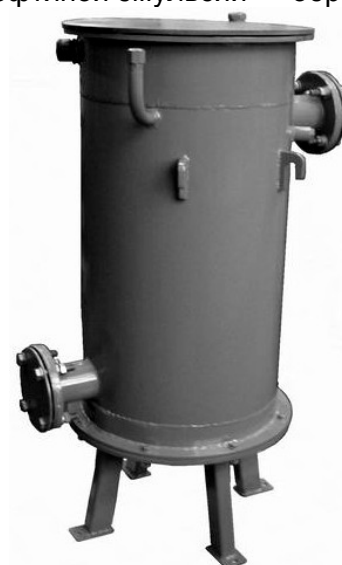
Рисунок 3 – Индуктивно-кондуктивное устройство для термоманитного воздействия
