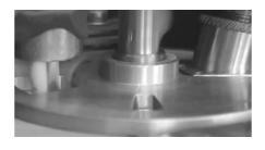
Рисунок 3 – Аппарат для определения температуры вспышки нефтепродуктов и момент вспышки паров опытного образца
