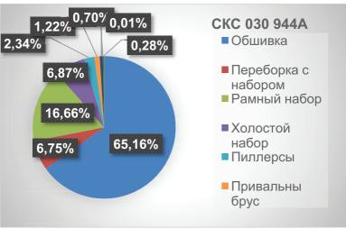
Рисунок 3 – Круговая диаграмма удельной зависимости использованного при модернизации металлопроката в процентах от общего его числа по проекту СКС 030.944A
