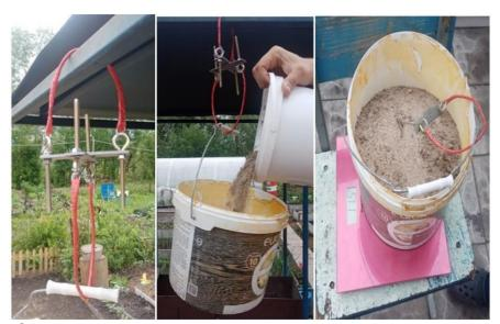
Рисунок 1 – Экспериментальная установка для определения адгезии методом отрыва
