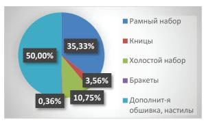
Рисунок 8 — Круговая диаграмма процентного соотношения масс всех элементов конструкций по всем оговоренным проектам модернизации
