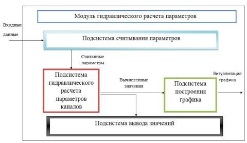
Рисунок 1 – Структурная схема модуля гидравлических расчетов параметров открытых канапов
