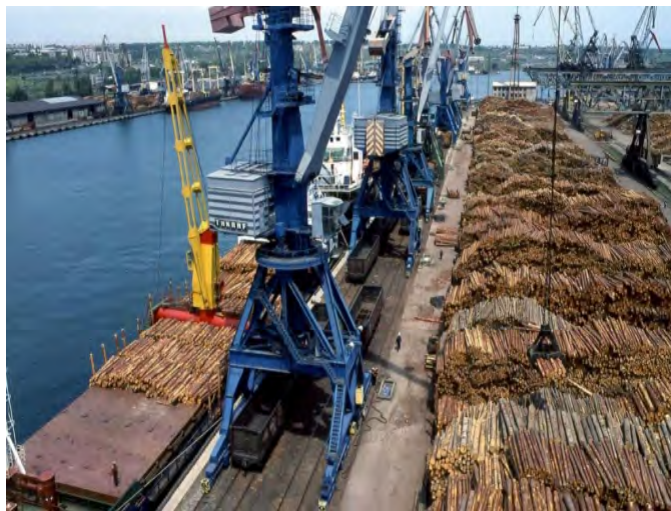
Рисунок 6 – Выгрузка речного судна с круглым лесом при помощи лесных грейферов
