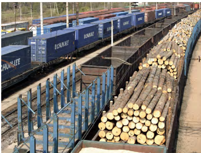
Рисунок 3 – Перевозка круглого леса в железнодорожных полувагонах с деревянными стойками, скреплёнными сверху металлической проволокой
