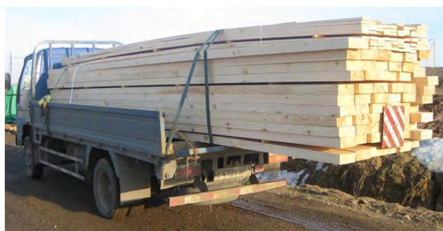
Рисунок 5 – Перевозка грузовыми автомобилями пиломатериалов закреплёнными с кузовом специальной прочной капроновой лентой
