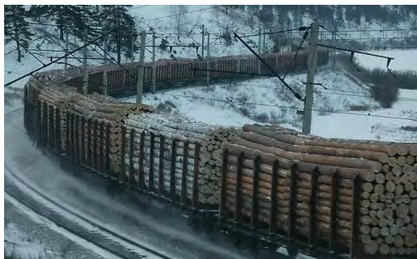
Рисунок 1 – Перевозка круглого леса на железнодорожных платформах с металлическими стойками, скрепленными сверху металлической проволокой
