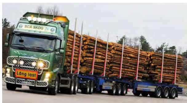
Рисунок 4 – Перевозка круглого леса автомобилями с прицепами, с металлическими стойками, скреплёнными металлической проволокой
