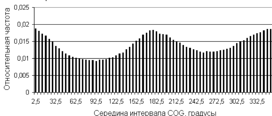
Рисунок 3 – Линейная гистограмма эмпирической плотности распределения COG GPS-приёмника SPR-1400 в летних наблюдениях
