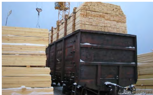
Рисунок 2 – Загрузка полувагонов пиломатериалом с креплением деревянными стойками и металлической проволокой
