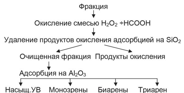
Рисунок 2 – Схема эксперимента окислительного обессеривания
