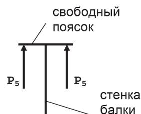
Рисунок 5 – Расчетная схема для оценки усилия  $P_5$
