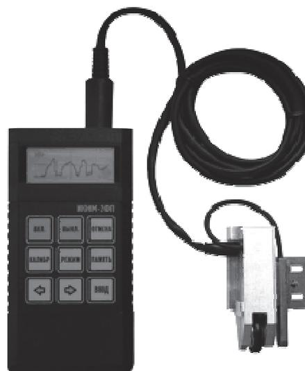
Рисунок 2 – Измеритель концентрации напряжений магнитометрический ИКНМ-2ФП
