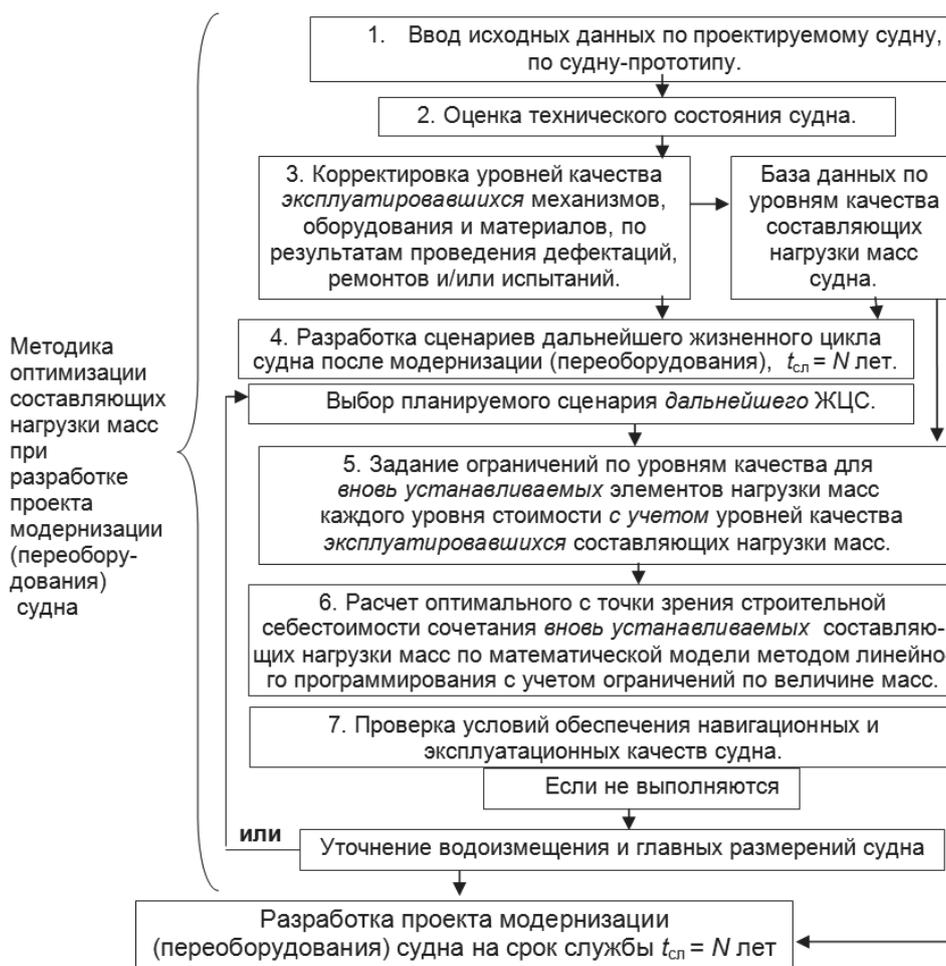
Рисунок 2 – Блок-схема планирования жизненного цикла при разработке проекта модернизации (переоборудования) судна
