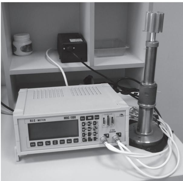
Рисунок 2 – Прибор для определения коэффициента объемного расширения нефтепродуктов
