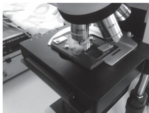
Рисунок 2 – Опытный образец ячейки на столике микроскопа
