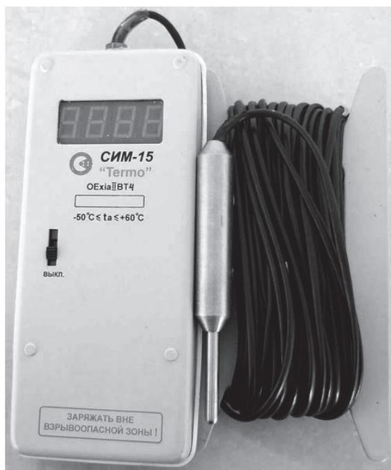
Рисунок 5 – Измеритель СИМ-15 «Термо»
