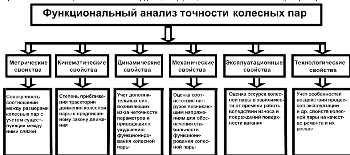
Рисунок – Функциональный анализ точности и его влияние на работоспособность и ресурс колесных пар
