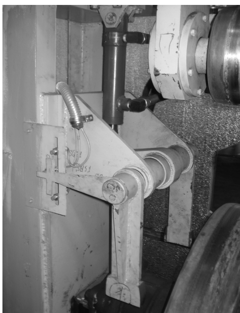
Рисунок 2 – Механизм осевого нагружения стенда СВРОН-1 и место установки датчика в осевом направлении на буксовом узле
