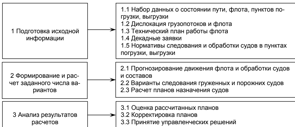
Рисунок 1 – Блочная структура имитационного моделирования
