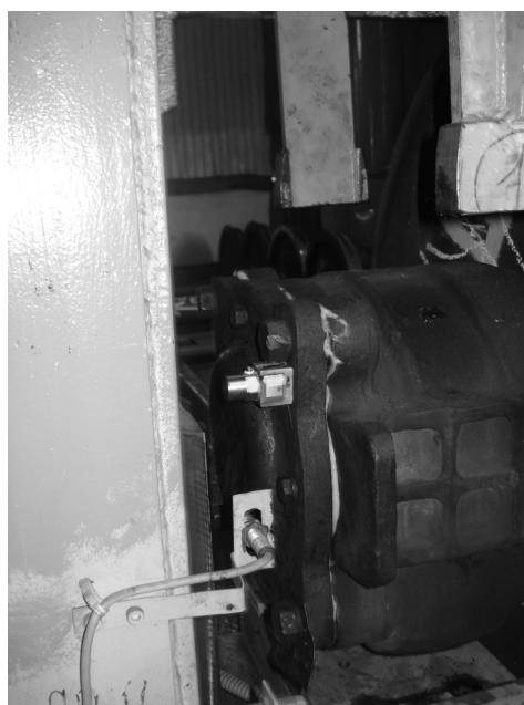
Рисунок 2 – Механизм осевого нагружения стенда СВРОН-1 и место установки датчика в осевом направлении на буксовом узле
